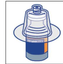
Sujetándolo por el envase, coloque el adaptador del vial sobre el vial hasta que encaje
