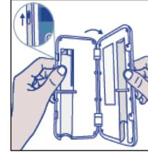
Deslice el pestillo de la tapa para desbloquear y abrir la tapa de la bomba
