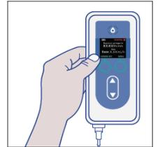
Vuelva a colocar la bomba en su orientación original. Compruebe que no gotea solución.
